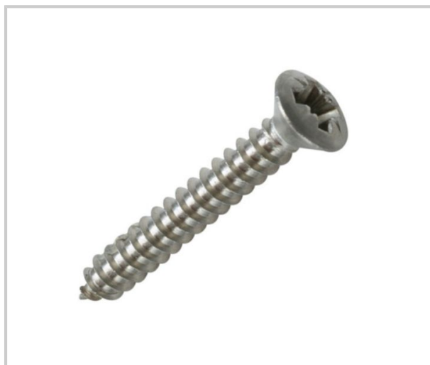
Vis tôle tête fraisée bombée cruciforme Acier zingué blanc NFE 25657
