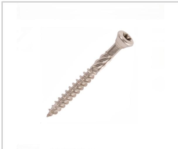
Vis terrasse bois Deck Origin inox A2 avec tête fraisée réduite, moletage central, pointe anti-fendage.
