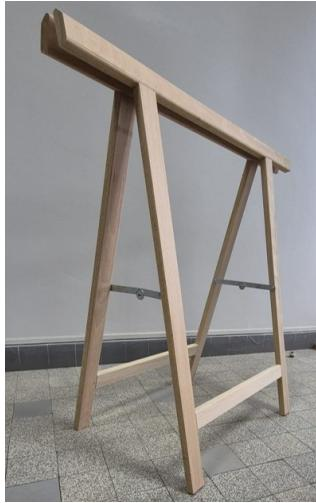
Hêtre assemblé par tenons et mortaises, chevillé, collé compas zingués de 200 mm charnières zinguées de 50 x 30 mm hauteur ouvert : 750 mm largeur : 770 mm section des bois : 40 x 18 mm.
