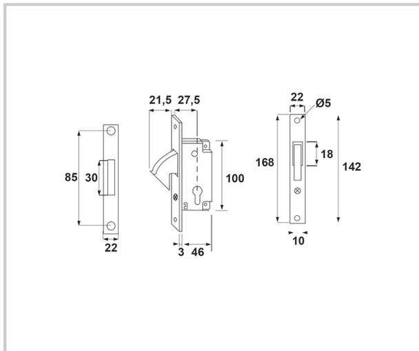
Serrure à crochet rentrant avec gâche et cylindre 3 clés
