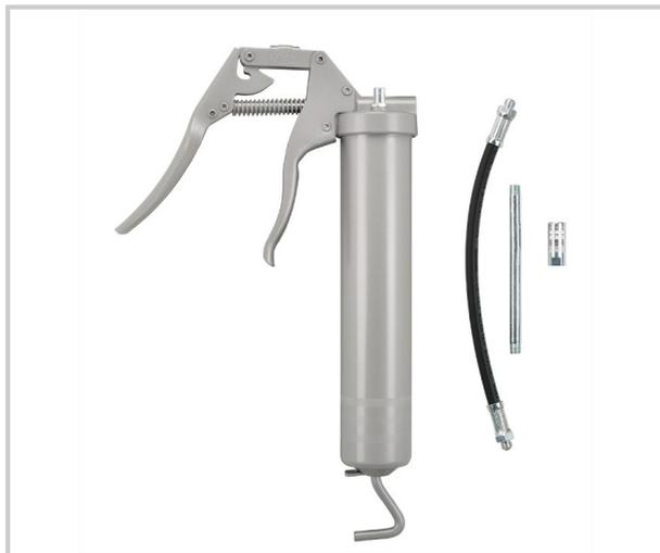
Permet d'utiliser des graisses jusqu'à la classe NLGI 2 en cartouche de 400 gr ou vrac équipé d'un flexible haute pression, M 10 x 1 / 8 x 300 mm, d'un bec rigide droit M 10 x 1 / 150 mm, d'un embout hydraulique M 10 x 1 et d'une valve de remplissage (FN), M 10 x 1 m
