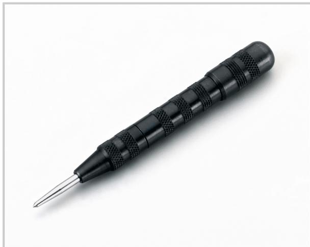
Petit pointeau automatique en acier chrome-vanadium bruni équipé d'un capuchon de réglage de la puissance de frappe puissance de frappe maximum 20 kg longueur x diamètre : 125x12 mm pointe interchangeable de Ø 4 mm.
