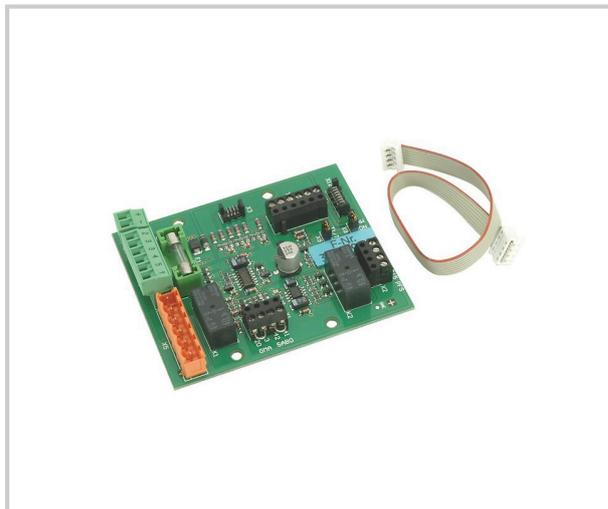
Prévue pour le raccordement de deux verrouillages TV au maximum, d'un commutateur à clé ST ou autre système de contrôle d'accès (hors fourniture DORMA), d'équipement de signalisation et d'alarme TG/TE, d'une lampe flash BL ou d'une sirène d'alarme externe AS, sur centrale de détection incendie GMA ou d'un détecteur de fumée RM pour raccordement sur contact libre de potentiel.
