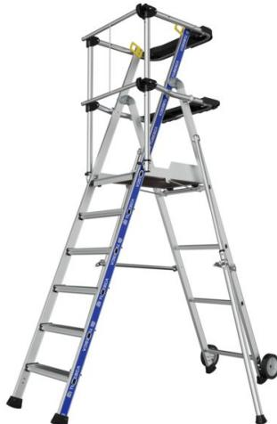
Garde-corps rigide 4 côtés avec lisses de protection antichute arrière à fermeture semi-automatique marches antidérapantes 80 mmporte-outils compartimenté amovible, résistance 25 kg, avec crochets intégrés (maxi 10 kg)tablette XL résistance 25 kgstabilisateurs rétractables à réglage millimétriqueplancher grand confort 600 x 400 mm antidérapant en bois éco-sourcéespace de travail ergonomique et confortableroues de déplacement tout-terrain Ø175 mm.
