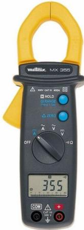
Afficheur 4000 points avec bargraphe 42 segments diamètre d'enserrage : 30 mm courant : - AC 40 et 400 A - DC 40 et 400 A tension : - AC 400 et 600 V - DC 400 et 600 V résistance 400 OHM test sonore de continuité, test diode fonctions : HOLD/ZERO DC automatique.
