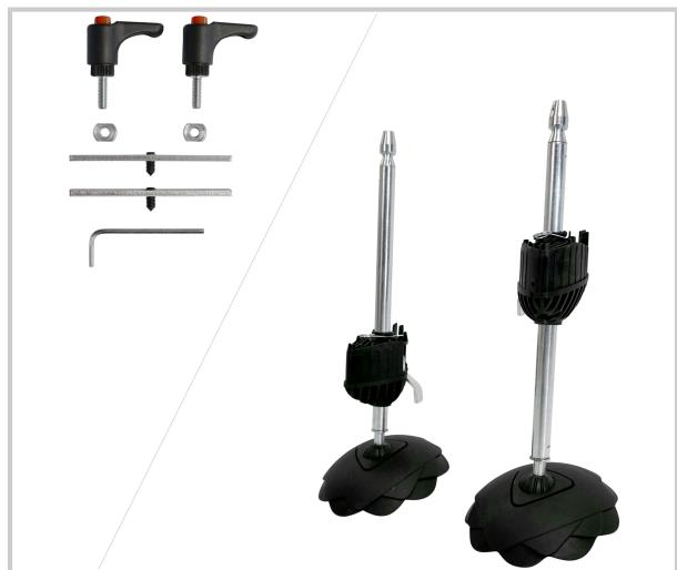
Adaptabilité à toute surface sur sol bosselé, pente ou surface inégale, assurent que l'échelle soit toujours bien de niveau. Paire de pieds de sécurité ajustable pour Prime 3m et Prime avec stabilisateurs ajustables jusqu'à 22cm, sur rotules à 360°, diamètres de 15,5cm par pied hauteur produit nu: 37 cm poids produit nu: 1,1 Kg.
