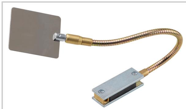
Permet de suivre le soudage dans les endroits inaccessibles.
