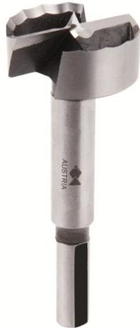
Applications: bois tendre ou dur pour le perçage de trous précis à cote constante, de demi-lune ainsi que trous en biais coupe ondulée brevetée "Wave Cutter" évitant l'échauffement pointe de centrage 2 traçoirs, 2 coupes dégageuses queue 3 pans décolletée de longueur 30 mm.
