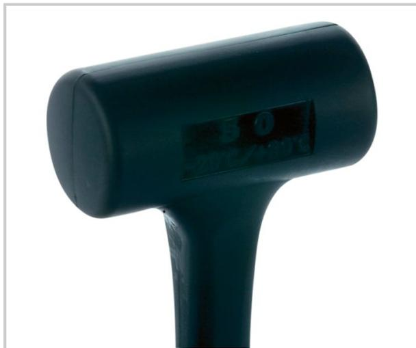
Effet sans rebond, tête partiellement remplie de billes d'acier. effet d'inertie lors de la frappe. dureté faible : A86 (limite le risque d'éclat des pièces métalliques frappées). surmoulage intégral : NBR Nitrile Rubber, résistant de -20°C à +90°C (évite la rupture de la tête et l'échappement des billes). utilisation : montage, assemblage, positionnement de pièces, idéal pour les phases d'ajustage précis.
