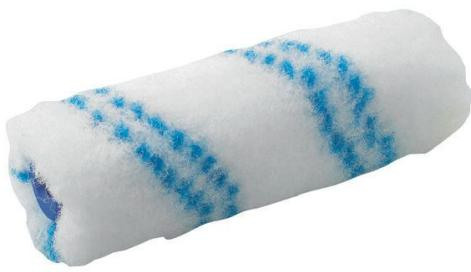
Polyamide texturé court 12 mm finition pommelée/pochée garnissant et résistant, bords biseautés recommandé pour les peintures phase aqueuse ensemble de 10 manchons 110 mm.
