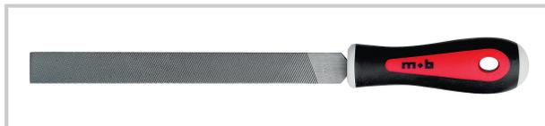
Grande longévité de la coupe grâce à l'acier fortement chargé en carbone (1,3 à 1,4 %) acier allié au chrome pour obtenir un mordant puissant dureté de 65 à 12 HRC manche bi-matière : polypropylène (résistance et relief permettant de travailler avec précision) et élastomère (souple et confortable - limite la transpiration et l'échauffement de la main).
