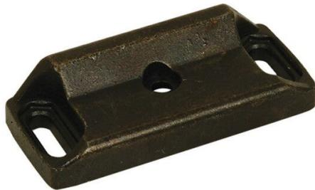
Gâche en zamac, utilisable su portes à deux vantaux, pour serrures centrales et pênes haut-bas (à exclusion de l'art. 8401!), réglable en vertical et en horizontal.
