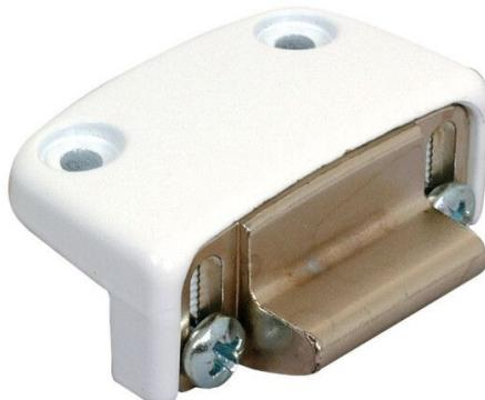
Gâche en zamac pour serrures centrales et pênes haut-bas (à exclusion de l'art. 8401I), utilisable sur portes à deux vantaux, réglable en vertical et applicable sur profils avec recouvrement de 16 à 26mm, sans l'aide de cales supplémentaires.
