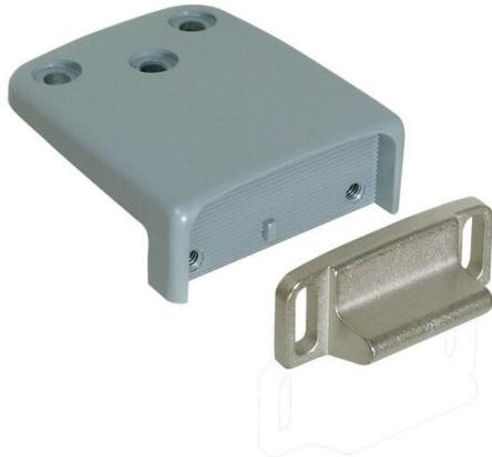
Gâche en zamac pour serrures centrales et pênes haut-bas (à exclusion de l'art. 8401I), utilisable sur portes à un et deux vantaux, réglable en vertical et applicable sur profils avec recouvrement de 16 à 26mm, sans l'aide de cales supplémentaires.
