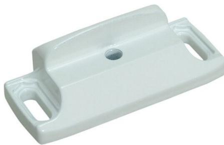
Gâche en zamac pour serrures centrales et pênes haut-bas (à exclusion de l'art. 8401I). Elle peut être réglée en horizontal et appliquée sur profils coplanaires et sur ceux à recouvrement jusqu'à 10 mm, sans l'aide de cales supplémentaires.
