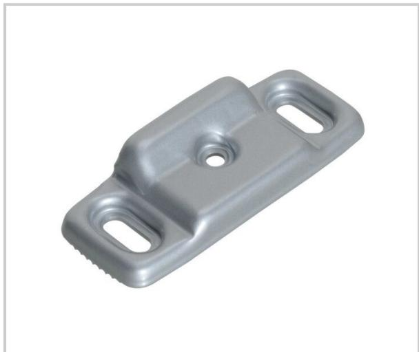
Gâche en tôle d'acier laqué pour serrures centrales et pênes haut-bas (à exclusion de l'art. 8401), utilisable sur portes à deux vantaux. Réglable en horizontal et applicable sur les profils coplanaires et sur ceux avec recouvrement jusqu'à 6mm, sans l'aide de cales supplémentaires. Apte pour portes coupe-feu.
