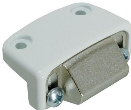
Gâche en zamac pour serrures centrales et pênes haut-bas (à exclusion de l'art. 8401I), réglable en vertical et applicable sur les profils avec recouvrement de 14 à 26mm, sans l'aide de cales supplémentaires.
