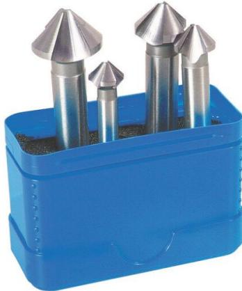
En acier rapide HSS au Cobalt (C05), fraise conique à 90°, 3 coupes. permet de chanfreiner l'emplacement de la tête de vis travaille sans vibrations et sans bavures. convient presque à toutes les matières (bois, aluminium, tôle, inox...) composition : Ø 10,4-12,4-16,5-20,5 mm.
