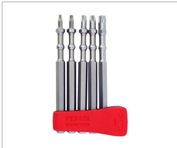
Embout à chocs Impact Ball haute durabilité (30x plus résistant) fabriqué en alliage VoHA VESSEL haute durabilité 62HRC conception avec double zone de torsion et bille d'absorption des chocs assurant plus de longévité de l'embout et moins de destruction de la vis idéal pour les visseuses à chocs et à puissante motorisation fourni en étui magnétiseur en plastique avec inserts de rangement des embouts permettant de magnétiser et démagnétiser l'embout souhaité étui magnétiseur de 5 embouts 90 mm.
