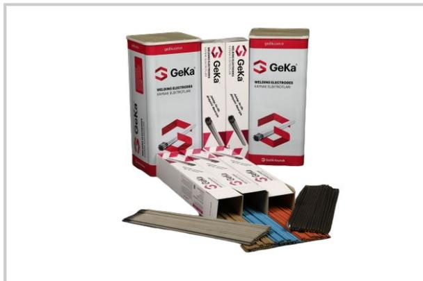
Électrode rutile à basse teneur en carbone pour le soudage des aciers Cr- Ni de type 23 Cr/13 Ni et soudures hétérogènes entre aciers inoxydables et aciers non alliés convient également en sous-couche avant rechargement dur positions de soudage : toutes sauf verticale descendante polarité : C (+) AC.
