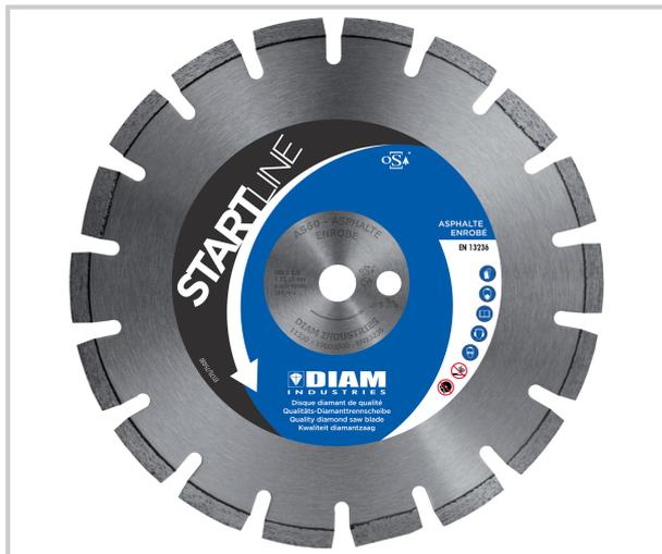
Recommandé pour les découpes des asphaltes, enrobés, matériaux abrasifs segments inclinés : protection contre le laminage sous segment conçu pour machines jusqu'à 9,5 kW.
