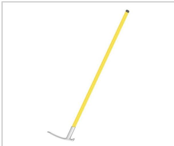
Pour démonter les coffrages lors du décoffrage des dalles en béton
