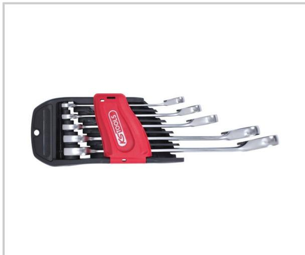
Mécanisme de cliquet intégré à la fourche angle de fourche 15° oeil incliné à 15° cliquet réversible 72 dents finition satinée chrome vanadium.
