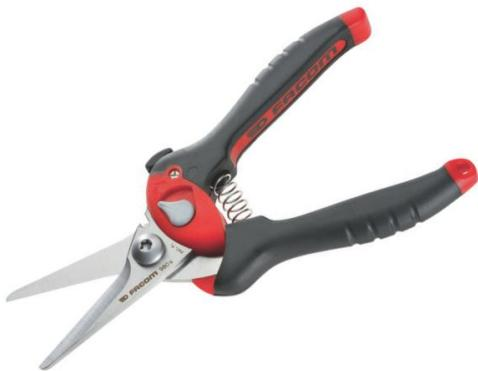
Gaine bi-matière permet la coupe de : plastique, feuillard, tôle fine de 0,5 mm , nylon de 5 mm , cuir, caoutchouc, câble électrique de 2,5 mm capacité d'ouverture maxi : 36 mm système de blocage en position fermée poids : 210 gr.
