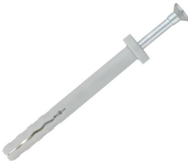
Pré-perçage avec une vis à tête fraisée avec marquage PZ peut être utilisée dans les matériaux pleins et creux dotée d'un collet cylindrique, conçu pour être utilisé dans des matériaux qui ne nécessitent pas une fixation à fleur ou qui ne peuvent pas être fraisés son filetage et sa pointe en forme de harpon facilitent l'installation, qui peut se faire à l'aide d'un coup de marteau.
