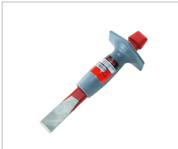
Tête de sécurité brevetée : pas de risque d'éclat et champignonnage réduit acier allié au Silicium d'excellente tenue mécanique 51SC7 réaffûtabilité à cœur à vires à la frappe extrêmement élevée outil forgé taillant agressif et résistant dureté de la zone travaillante 52-58 HRC peinture époxy cuite au four - pointe dégagée zone de préhension à chant plat équipée d'une poignée pare-coups.
