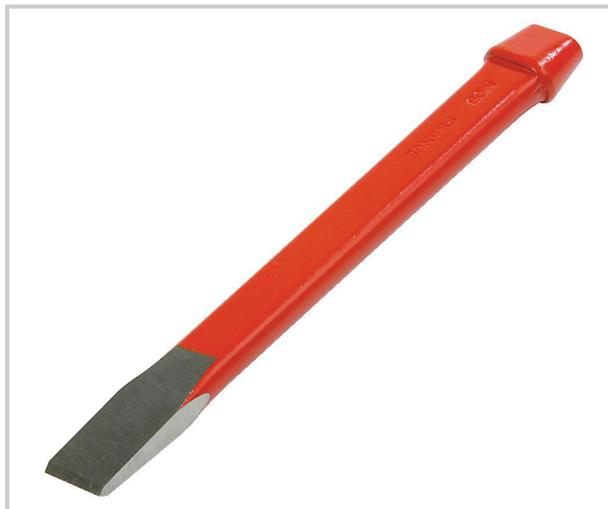
Tête de sécurité brevetée : pas de risque d'éclat et champignonnage réduit acier allié au Silicium d'excellente tenue mécanique 51SC7 réaffûtabilité à cœur à vie Rendement à la frappe extrêmement élevé outil forgé taillant agressif et résistant dureté de la zone travaillante 52-58 HRC peinture époxy cuite au four - pointe dégagée zone de préhension à chant plat : meilleure tenue.
