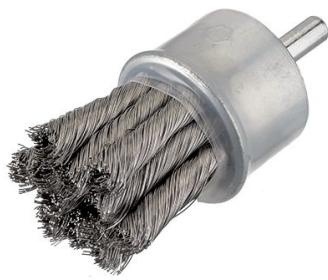
Ces brosses se caractérisent par leur efficacité et leur flexibilité. Grâce à la force centrifuge créée par la vitesse de rotation, la brosse s'ouvre et se ferme dès l'arrêt de la rotation. Pour cardage, ébavurage, enlèvement de laque et de scories, détartrage, dépolissage, nettoyage. Parfaitement adaptées pour le nettoyage d'alésage.
